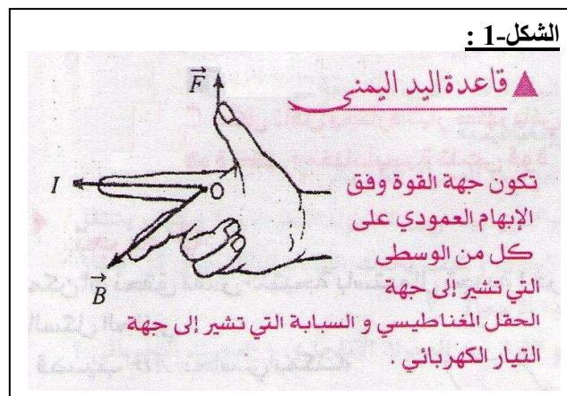
الشدة : تتعلق بشدة الحقل المغناطيسي و طول الناقل و شدة التيار الكهربائي المار بالناقل ، فهي حسب قانون لابلاص تعطى بالعبارة التالية :
